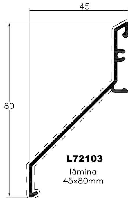
SÉRIE L72000 - LÂMINAS DE PROTEÇÃO SOLAR
