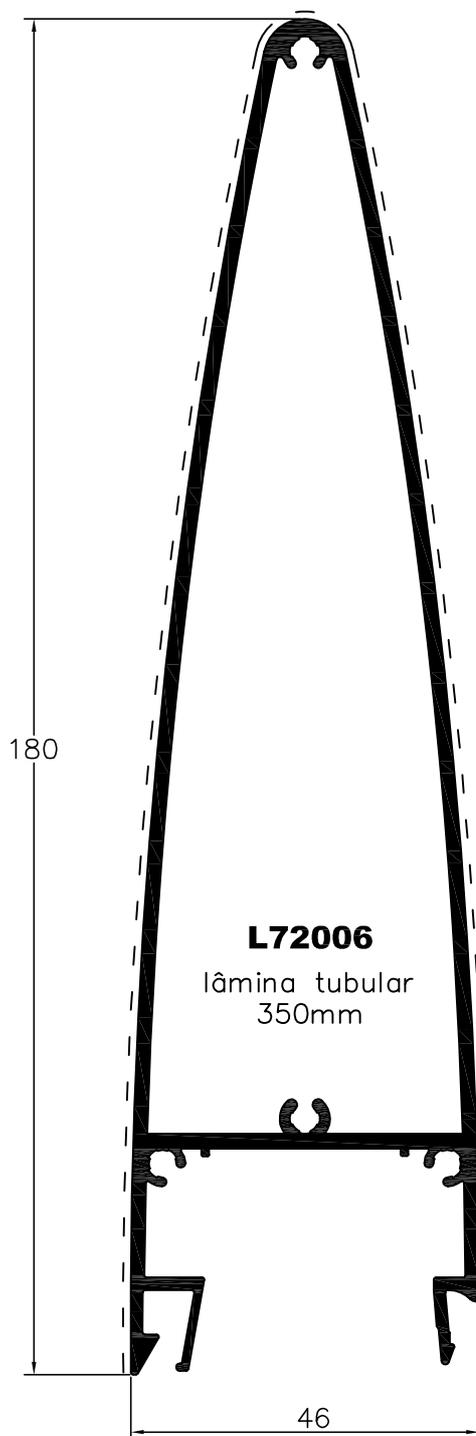
SÉRIE L72000 - LÂMINAS DE PROTEÇÃO SOLAR
